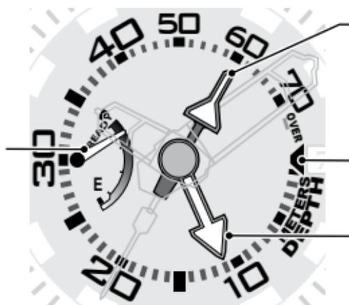
Aiguille de profondeur d'eau maximale : indique la profondeur maximale pendant une mesure.
