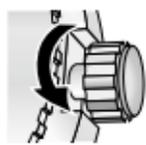
逆時針旋轉緊鎖螺絲，直至鬆動。   |
