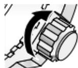
將旋鈕推至錶殼內。輕壓錶殼，順時針旋轉旋鈕，將其固定在錶殼上。確保擰緊。 |
