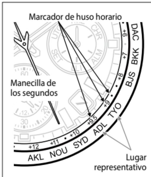
En la ilustración de la izquierda, la manecilla de los segundos señala 26 segundos y el ajuste del huso horario es «+10,5».
