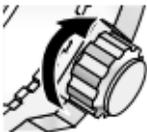
Presione la corona hasta introducirla en la caja. Gire la corona en sentido horario y, al mismo tiempo, presiónela con suavidad en dirección de la caja para fijarla en la misma. Apriete con firmeza.<br>El diagrama muestra una mano presionando y girando la corona hacia la derecha. |
